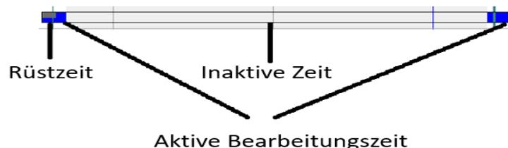
Am Anfang vieler Arbeitsgänge steht zunächst eine Rüstzeit. Dieser Rüstzeit-Anteil wird im **etagis APS** dadurch gekennzeichnet, dass der Balken zur Hälfte schwarz ist und nur in der anderen Hälfte die normale Farbe hat.
