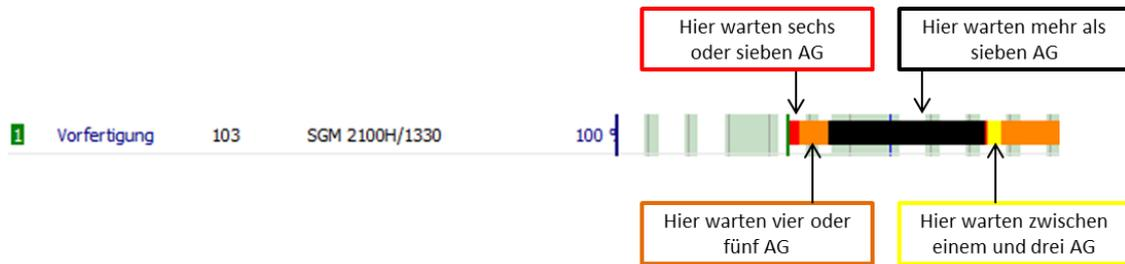
Im aufgeklappten Fall wird oberhalb des breiten Balkens für jeden einzelnen Arbeitsgang, der vor der Ressource wartet, ein schmaler Zeitstrahl angezeigt, der angibt, von wann bis wann dieser Arbeitsgang warten muss.
